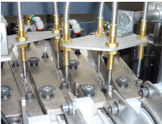
I sensori controllano e regolano i rifornimenti dei particolari nelle guide di alimentazione.
