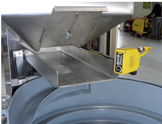
Un vibro alimentatore consente la regolare alimentazione del sistema.
