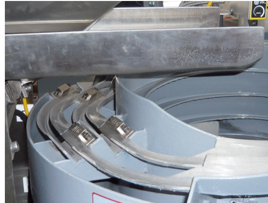
I dadi sono preselezionati nel corretto senso di installazione.
